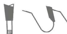
Dientes ATB bisel superior alterno
