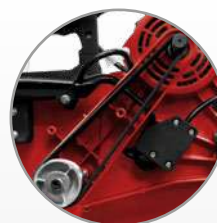
Transmisión por correas. Máquina silenciosa
