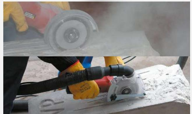
**Cárter de aspiración para desbaste 125 mm**
