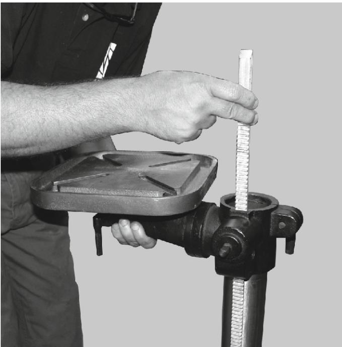
Sujete la cremallera y deslice la mesa por la columna hacia abajo junto con la cremallera, hasta que ésta apoye en el soporte de la columna.
