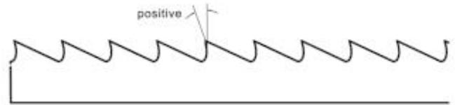
Para uso particular o de cruz inclinada recortes en estado sólido o grandes secciones de tuberías, pero por encima de todos los materiales más difíciles (muy aleados y aceros inoxidables, bronce especial y forjar arrabio).
