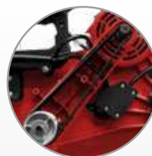
Transmisión por correas. Máquina silenciosa
