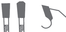
Dents TCG coupe plane trapézoïdale aluminium et métal
